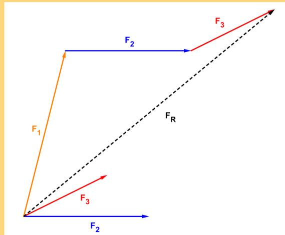
Rechnerisch bestimmt man unbekannte Kräfte durch die Winkelfunktionen, den Sinus- und Kosinussatz oder durch das Zerlegen der Kräfte in horizontale und vertikale Komponenten.
